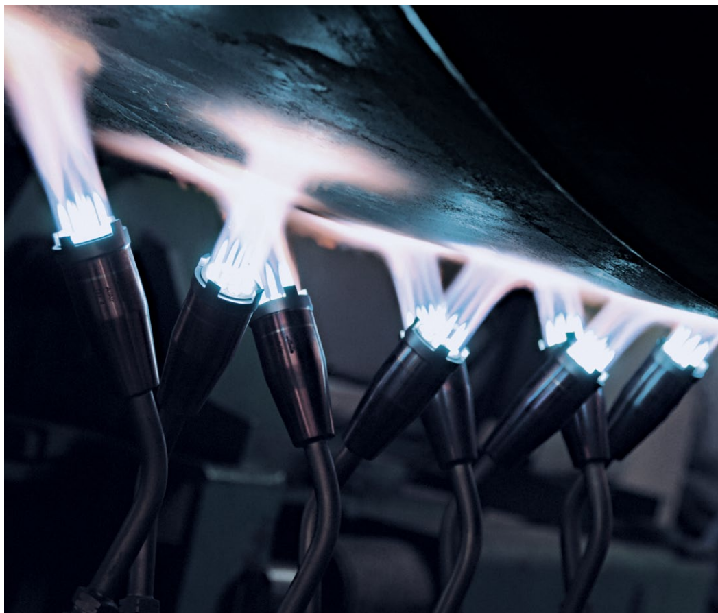
LINDOFLAMM LF-H-8x2D, en typisk manuell förvärmningsbrännare
