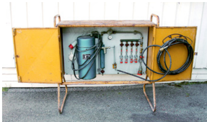
Förångare, kapacitet 32 kg gasol/timme. Mått ca B 80 x H 111 x D 40 cm. Ansluts till 380 V, 6 kW..
