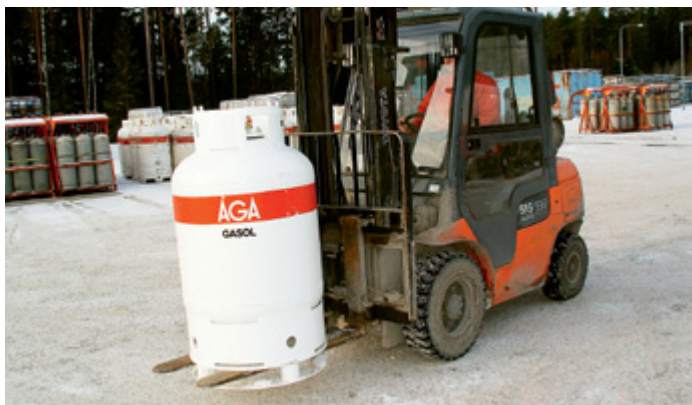
Maxiflaska med 184 kg gasol. Uttag finns för både gasfas och vätskefas..
