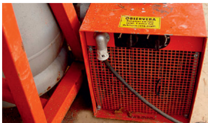
Värmebläkt skyddsklass IP 44. Effekt 5 kW, 380 Volt. Termostat max 40°C temperatur.
